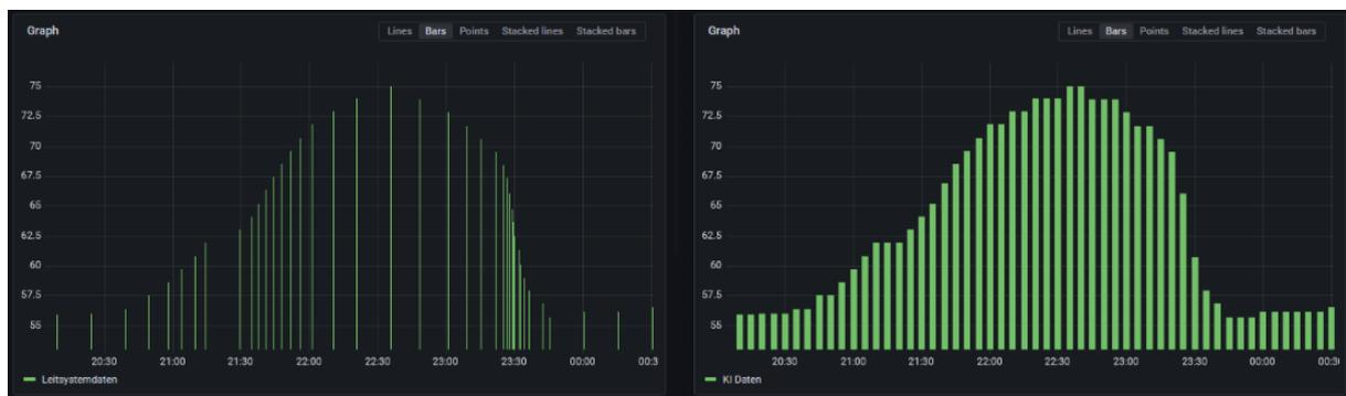
Abbildung 21: Eventbasierte Datenaufzeichnung und Reduzierung in feste Zeitscheiben
